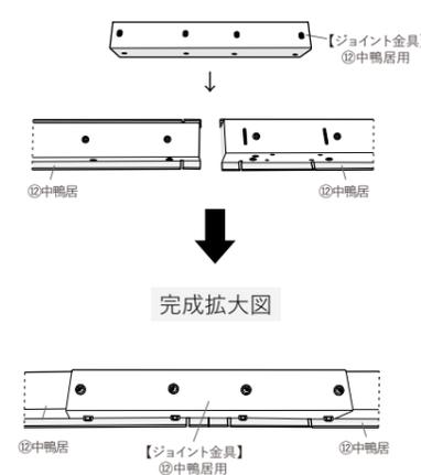
**11** 繋ぎ合わせた⑩中鴨居を⑧・⑨屋根側板(左・右)の長穴に合わせ、(A)とワッシャーで取り付けます。
