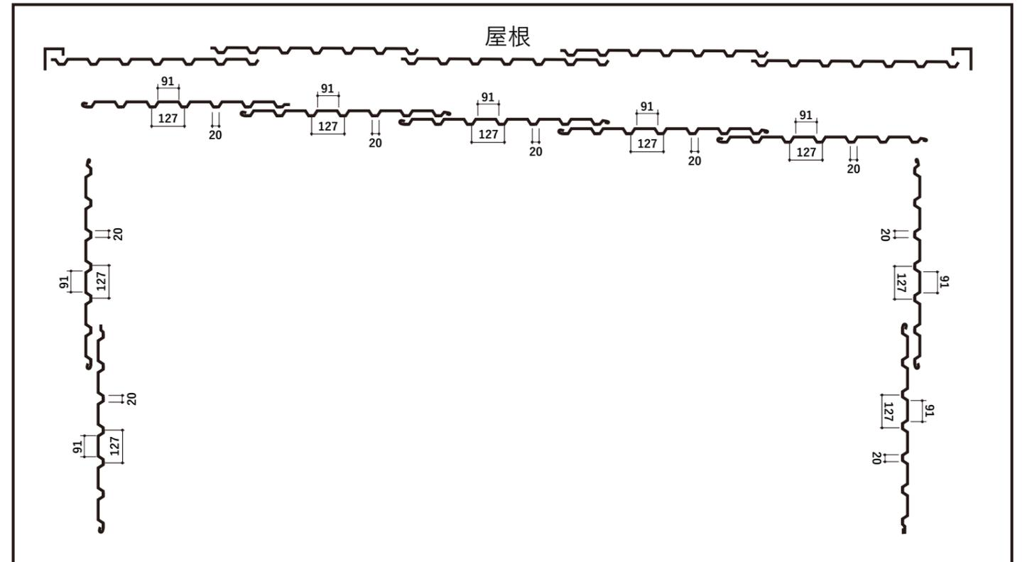
後側を先に取付け、前側を後側の上に400mm程重ねて取付けてください。
