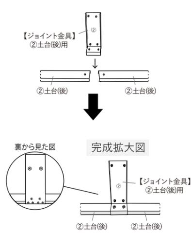
**3** 地面をならし、繋ぎ合わせた土台①(前)・②(後)と③(左・右)を水平に設置し、(A)で取り付けます。
