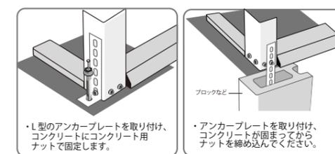
・L型のアンカープレートを取り付け、コンクリートにコンクリート用ナットで固定します。
