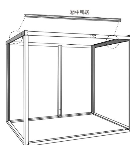
**12** ⑤と⑧でつなぎ合わせたジョイント部分にある中央上2つの(A)六角フランジネジを一度外して、前鴨居から後鴨居に向けて鴨居連結を上から被せます。被せたら先程外した(A)六角フランジネジを右図のように再度留めてください。
