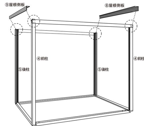
**6** ⑫中鴨居を⑧・⑨屋根側板(左・右)の長穴に合わせ(A)とフランジナットで取り付けます。
