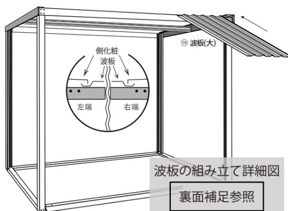
**8** ⑥前鴨居の隙間にフランジナットを入れ、手で押さえながら(A)で⑧・⑨側板の前面部分に⑳屋根前カバーを取り付け、⑰波板屋根パネルを⑳屋根前カバーに当たるまで後方から押してください。
