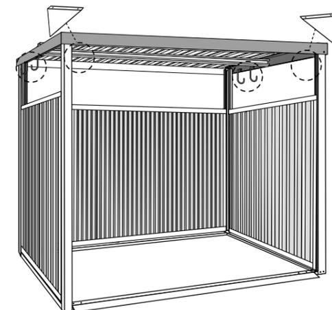
**【補強板の取り付け方】**
