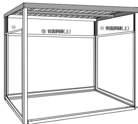
**13** ⑱波板を取り付け、㉓側面パネル押えと㉔背面パネル押えを⑫で取り付けした4ヶ所(⑬~⑰)と⑱波板の内側の隙間に入れ、(B)で固定します。(⑬⑭に穴はなく、⑬~⑰の穴から(B)を入れて押し固定する。)
