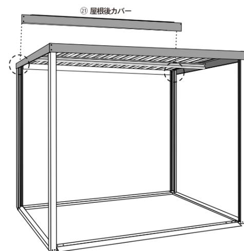
**10** ㉒波板屋根パネル押えを⑧・⑨側板の上から(B)で取り付けます。左2ヶ所 右2ヶ所
